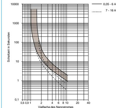
Die Zeit/Strom-Kennlinie ist abhängig von den Umgebungstemperaturen. Um eine vorzeitige oder späte Abschaltung zu vermeiden, muss der Schutzschaltstrom mit einem Temperaturfaktor multipliziert werden
