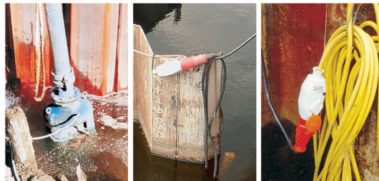
Der NIVA Niveauregler KR1 kann überall eingesetzt werden, wo Flüssigkeitsstände überwacht werden müssen. Das hochwertige TPK Kabel ist gegen eine Vielzahl von Medien beständig. Der Niveauregler KR1 kann auch in Kombination mit der NOLTA Schützkombination, dem NOLTA Motorschutzstecker 230 V oder dem NOLTA Kondensatorstecker geliefert werden.
